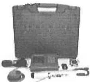
*Склерометърът Digi-Schmidt съчетава оригиналния склерометър Schmidt със сензор, измерващ стойността на отскока и микропроцесорна технология и е проектиран за приложения, изискаващи многобройни измервания.*
