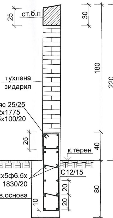
Разрез през плътна ограда Разрез 2-2
